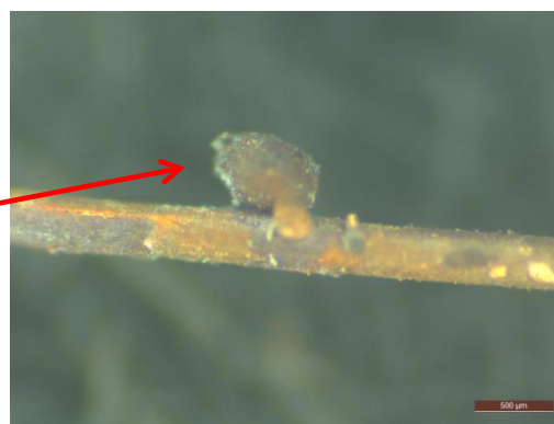
(b) 中间熔痕体式显微镜下局
